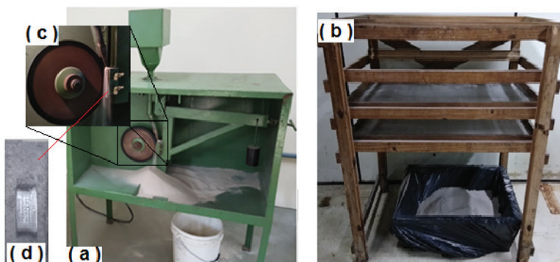
Figura 4: a) Abrasômetro tipo roda de borracha; b) Dispositivo de peneiramento de areia; c) Detalhe contato amostra roda de borracha; d) Superfície desgasta na amostra
