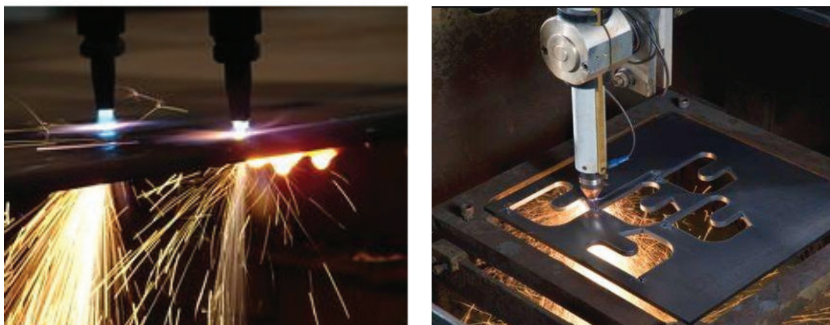
Figura 5: Representação de oxicorte (esquerda) de corte a plasma (direita)
