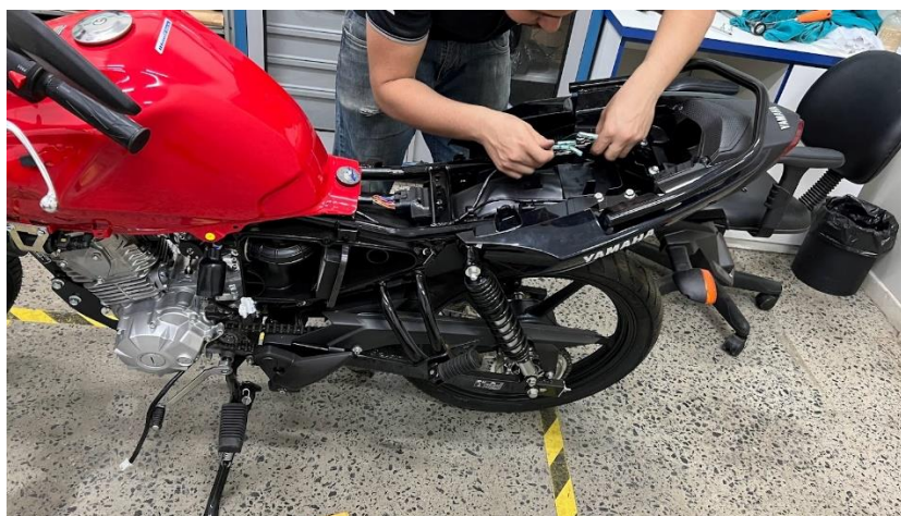
Figura 2 - Motocicleta Yamaha YBR 125i por tração à combustão em processo de desmontagem
