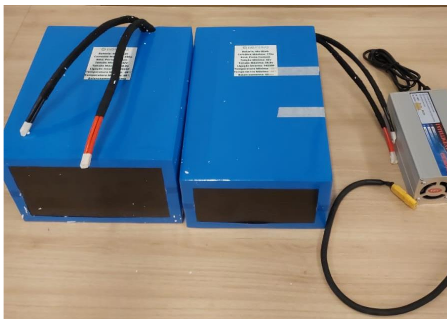
Figura 5 - Banco de bateria de lítio 48V 200Ah e seu respectivo carregador
