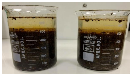
Figura 1 – Fibra da casca de banana ( Musa paradisiaca ) em banho de ácido cítrico.
