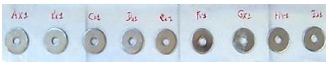
Figura 2 – Arruelas de aço galvanizados utilizadas nos ensaios de corrosão
