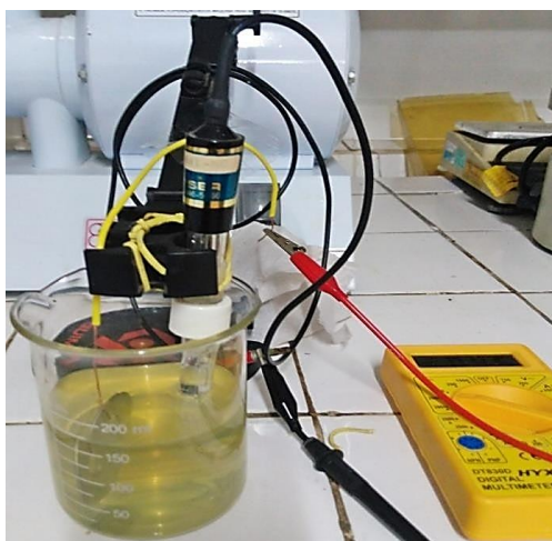
Figura 3 – Sistema para medição de potencial de corrosão
