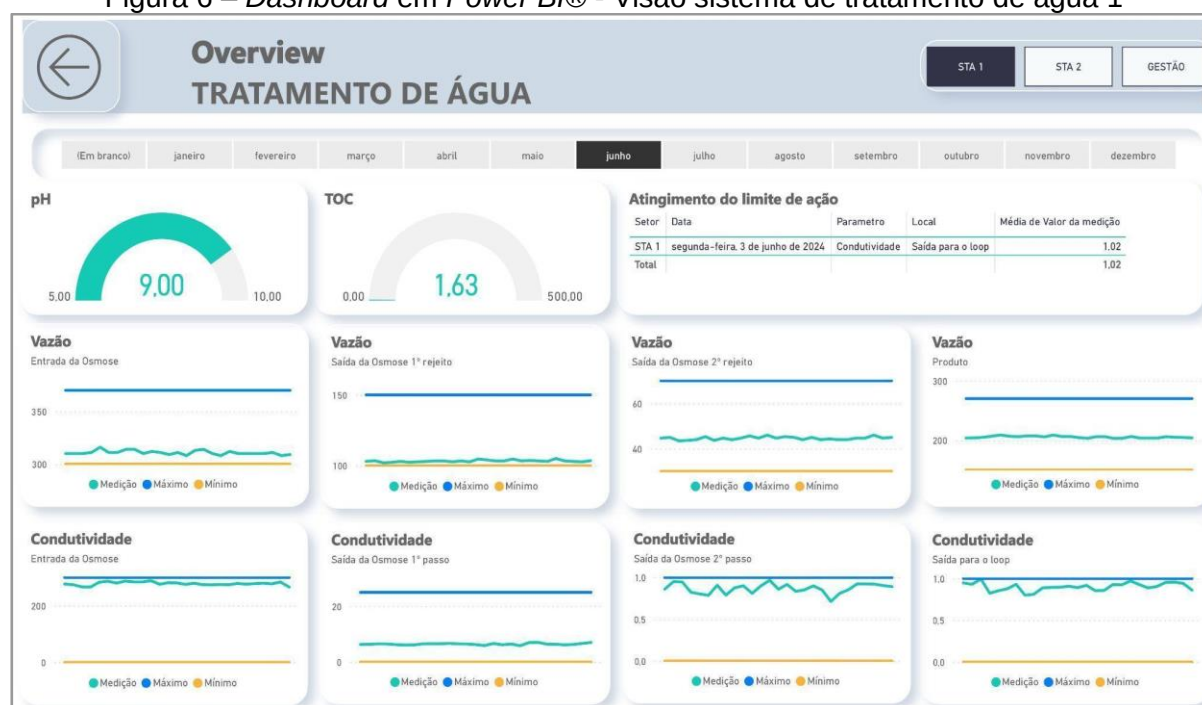
Figura 6 – Dashboard em Power BI® - Visão sistema de tratamento de água 1
