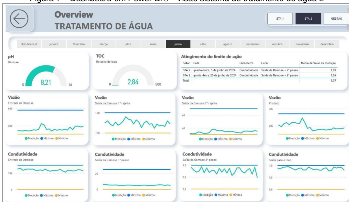
Figura 7 – Dashboard em Power BI® - Visão sistema de tratamento de água 2
