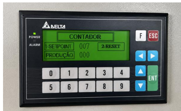
Figura 4 – Interface Homem-Máquina exibindo o contador de produção durante os ensaios.
