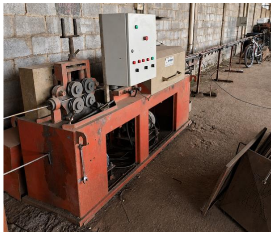
Figura 1 – Máquina desbobinadeira antes da realização do retrofit .
