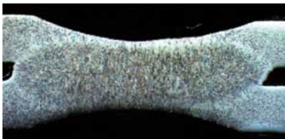
Figura 5: Indentação na superfície da chapa soldada criada pela pressão durante a soldagem
