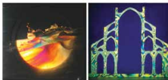
Figura 10: Observando o estresse dos materiais através polarizadores.
