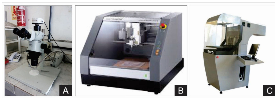
(A) Estereoscópio Olympus SZX16® - (B) Modeladora/Fresadora modelo Mdx 40 A® - (C) Máquina de corte e gravação à laser da marca Mira®. -
